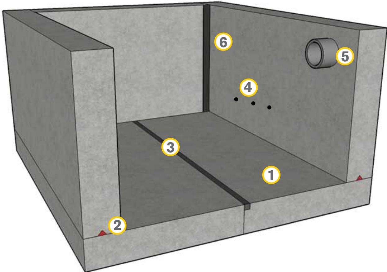
1. Agregue la Membrana Interna Krystol (KIM) a la mezcla de concreto para asegurar que el agua quede contenida. Ver Instrucciones de Aplicación de 1.11 a 1.15 — Uso del Aditivo KIM.
