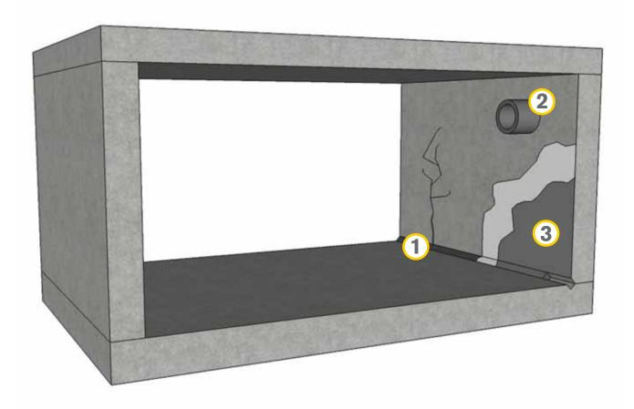
Impermeabilización por el lado negativo en estructuras subterráneas donde no se aplicó ninguna protección, o bien, donde la membrana de impermeabilización ha fallado.
