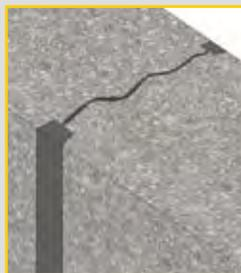
Dos canaletas alineadas pueden generar una grieta controlada, al empacar estas canaletas con un mortero impermeable externo, se asegura una protección impermeable y permanente integrando a la matriz del concreto la tecnología Krystol.
