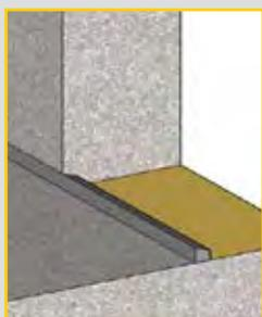
La tecnología Krystol asegura una protección impermeable permanente con la aplicación de la lechada de Krystol Treatment y el mortero externo Krystol Waterstop.
