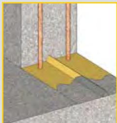
La tecnología Krystol para el tratamiento impermeabilizante de juntas le asegura una protección permanente ya sea con la instalación de triángulo interno o de la banda hidroexpansiva junto la lechada de Krystol Treatment.
