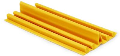
La banda inductora de grietas Kryton se instala en la cimbra de concreto o bien sobre los muros de apuntalamiento. Se traza y se forma un cajeadado directamente opuesto a la banda inductora. Después de haber colado el concreto, se desarrolla una grieta desde la banda inductora hasta el cajeadado. Se empaqa el cajeadado con el mortero Krystol Waterstop para proteger la junta.
